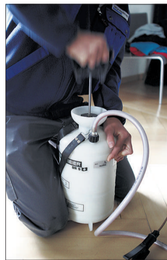
Druckbehälter mit Biozid.
