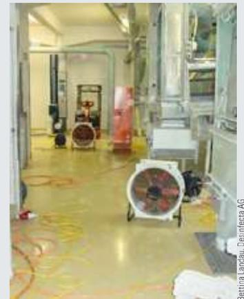
Abb. 3: Wärmebehandlung in einer Mühle. Die Hitze treibt verschleppte Schädlinge wie z. B. Reismehlkäfer aus den Anlagen und tötet alle Entwicklungsstadien ab. Nach der Hitzebehandlung ist der Befall in den behandelten Produktionsräumlichkeiten und -anlagen auf null gesenkt.
