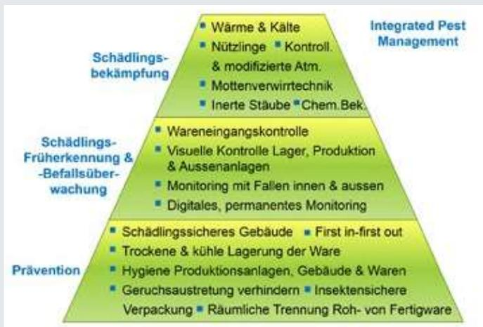
Abb. 2: Technische Aspekte des Integrated Pest Management (IPM). Die Prävention ist eine wesentliche Grundlage des IPM, während die Schädlingsbekämpfung eine geringere Rolle spielt. Durch alternative Bekämpfungsmethoden werden chemische Rückstände vermieden. Mit dem neuen digitalen Monitoring wird das Schädlingsvorkommen 24/7 überwacht.
